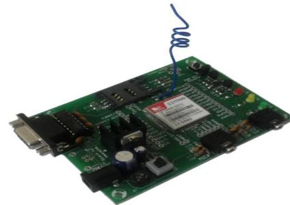
Fig:5: GSM Module
