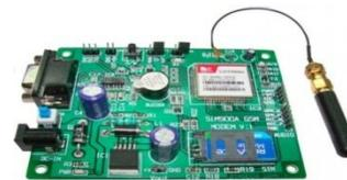
Fig 5: GSM module
