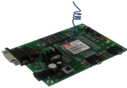
Fig: GSM Module
