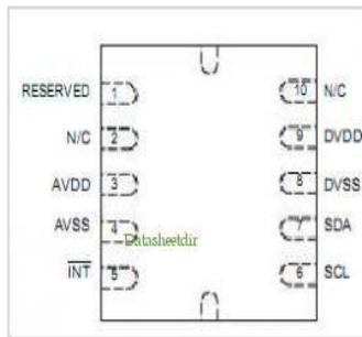
Fig 2: MEMS IC
