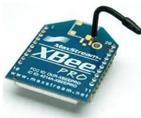
Fig 4: ZIGBEE module
