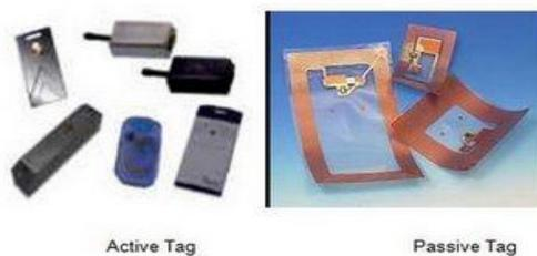
Fig 2 : RFID Module
