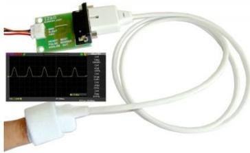
Fig: Pulse sensor
