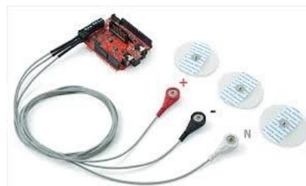
FIG: ECG Sensor
