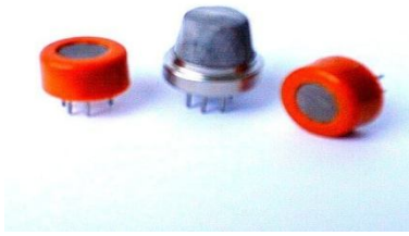
Fig: Gas sensor
