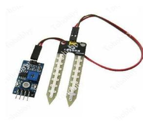
Fig: Soil sensor
