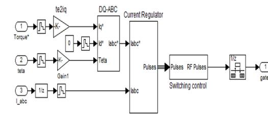
**Fig.8 (d) Subsystem of current controller**
